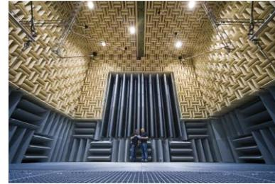
Fig. 1b: Banco de pruebas para ventiladores
